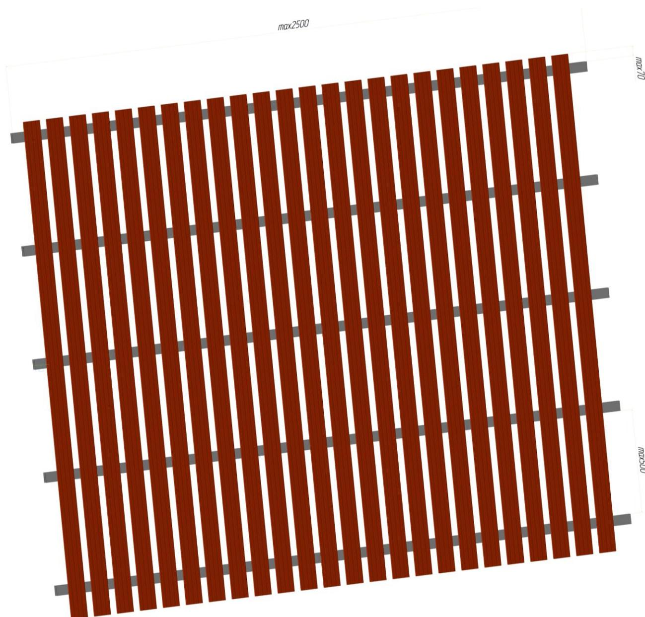
Расстояние между поперечинами не более 500 мм, количество поперечин зависит от высоты ограждения, длина пролета не более 2500 мм. Верхняя и нижняя поперечины устанавливаются так, чтобы вылет штакетин был не более 70 мм.
